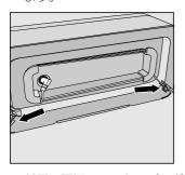
■ 付属の電源ユニットのプラグを充電ステーションの背面にあるソケットに挿入します。余ったコードをコード巻付部に巻き付けることができます。ケーブルを2つのケーブルガイドの1つに通します。
