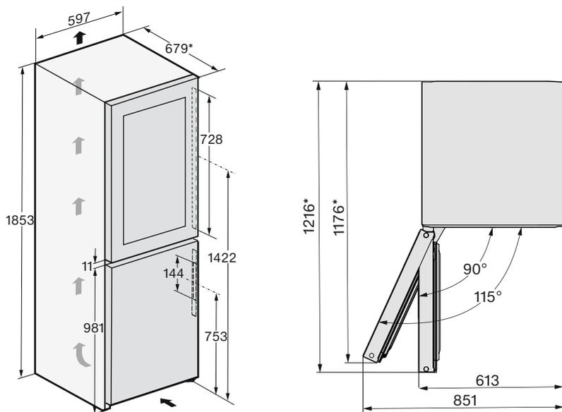
\* Medida sin soporte distanciador de pared. En caso de utilizar los soportes distanciadores de pared suministrados, la profundidad del aparato aumenta aprox. 15 mm.
