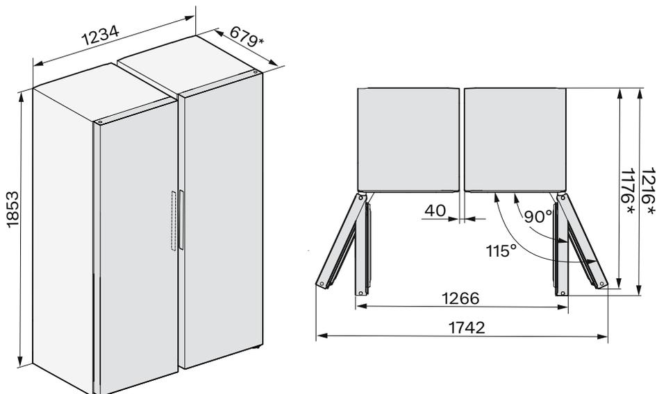
\* Medida sin soporte distanciador de pared. En caso de utilizar los soportes distanciadores de pared suministrados, la profundidad del aparato aumenta aprox. 15 mm.
