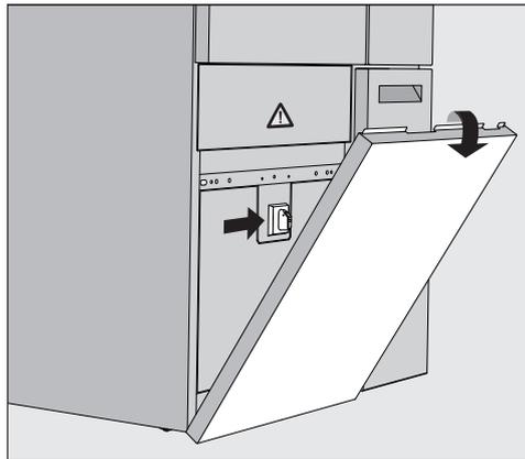
L'interrupteur principal permettant de séparer le laveur-désinfecteur du réseau électrique se trouve derrière la trappe de service.
