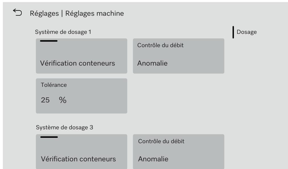
Les paramètres Contrôle du débit et Tolérance ne sont visibles que dans les laveurs-désinfecteurs avec Surveillance du dosage.
