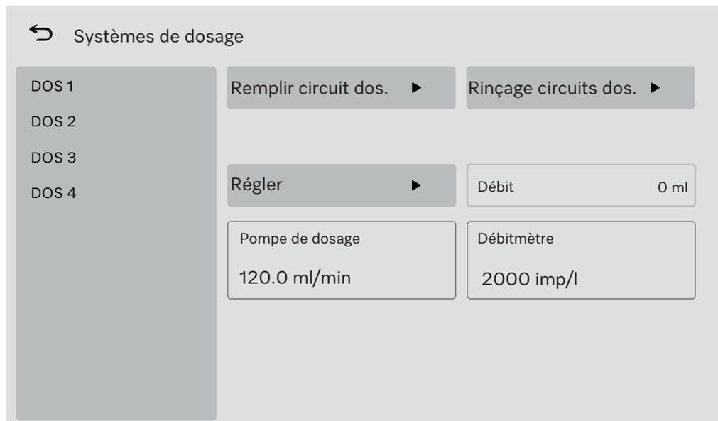
Remplir circuit dos. Si le réservoir contenant un produit chimique a été remplacé par un nouveau, la fonction Remplir circuit dos. doit être exécutée pour le système de dosage correspondant.
