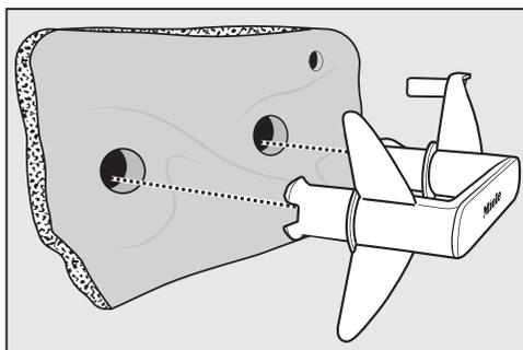
Les déformations indiquent que le filtre de socle est utilisé.
