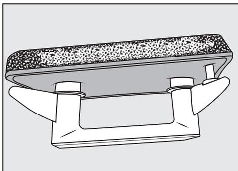
Les résidus sont des résidus de fibres du linge et de composants de lessive qui encrassent le filtre. Ces résidus se trouvent sur la face avant ainsi que sur les bords du filtre de socle. Dans les cas extrêmes, ces résidus forment des dépôts incrustés.
