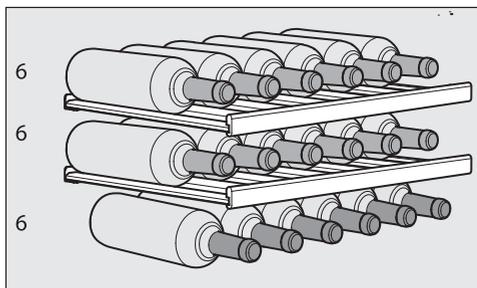
El aparato tiene capacidad máxima para 18 botellas (0,75 l; botella tipo Burdeos; altura máxima 310 mm).
