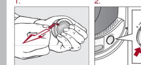
1. Drehen Sie den äußeren Ring nach links, bis sich die Markierung ② in Position ① befindet.
