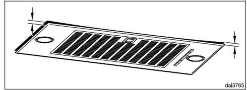
Sollte die Einbaufläche uneben sein und damit die flächenbündige Montage erschweren, kann der Rahmen nachjustiert werden.
