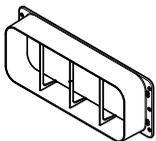
**1 Stutzen** zum Anschluss eines Flachkanals nach hinten oder zur Seite (nur Typenreihe ...EXTA)
