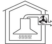
Bei Dunstabzugshauben, die für den Betrieb mit einem externen Gebläse vorbereitet sind, wird ein Miele Absauggebläse ausserhalb des Raumes an einem Standort Ihrer Wahl montiert. Das externe Gebläse wird durch eine Steuerleitung mit der Dunstabzugshaube verbunden und über Con@ctivity oder über die Bedienelemente der Dunstabzugshaube gesteuert.
