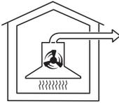
Die Dunstabzugshaube saugt die Kochdünste an. Die Luft wird dabei über das Randabsaugungspaneel und durch die Fettfilter geführt und gereinigt. Anschliessend wird die Luft nach aussen geleitet.
