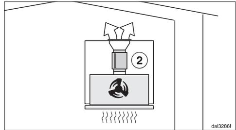
Bei Umluftbetrieb wird der Schalldämpfer zwischen Ausblasstutzen und Ausblaspitter positioniert ②. Prüfen Sie den Einbauraum.
