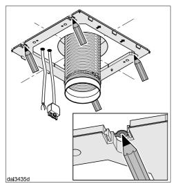
Utilize a moldura distanciadora como molde para efetuar os orifícios. Coloque a moldura no teto, as setas devem ficar voltadas para frente. Alinhe a moldura distanciadora pelos entalhes com a linha traçada e marque os orifícios a perfurar.
