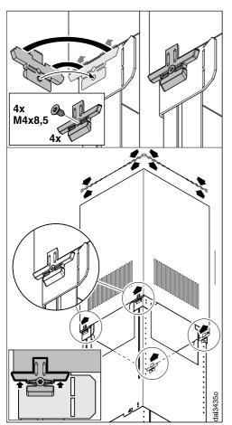
Coloque os quatro fixadores do revestimento telescópico. Aparafusando os parafusos de fixação afasta o fixador e pressiona o revestimento telescópico para cima.
