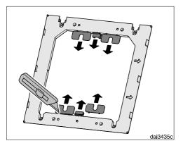
Com uma faca solte as quatro peças de compensação e os dois frisos da moldura distanciadora fornecida junto.
