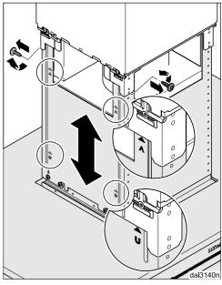
Volte a desaparafusar os dois parafusos do suporte.
