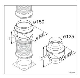
Além do isolamento do tubo de saída de ar, recomendamos a instalação de uma barreira de condensação, que absorve e evapora a condensação.
