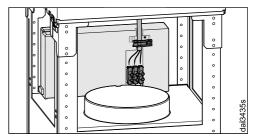
Para uma ligação adequada, é necessário utilizar o passador de fios existente.
