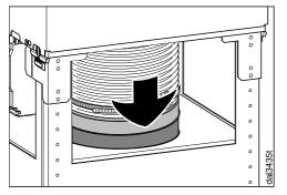
Encaixe o tubo de saída de ar no canhão de saída de ar
