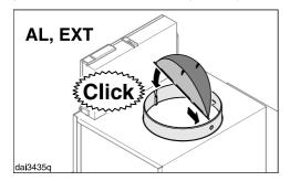
O sistema de funcionamento por saída de ar (AL, EXT) é feito com a tampa anti-retorno montada, se o seu sistema não estiver equipado de acordo.
