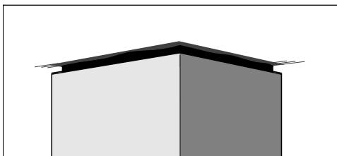
Ανάμεσα στο καμίνι και την οροφή μπορεί να τοποθετηθεί ένα **πλαίσιο απόστασης**. Μπορεί να χρησιμοποιηθεί, αν είναι επιθυμητή για οπτικούς λόγους μια απόσταση ανάμεσα στην οροφή και το καμίνι (κενό σκίασης). Αυτό μπορεί να είναι απαραίτητο για παράδειγμα, όταν η οροφή δεν είναι οριζόντια ή δεν είναι επίπεδη. Ο απορροφητήρας ευθυγραμμίζεται κάθετα με τις συνοδευτικές ταινίες αντιστάθμισης. Οι οπτικές ανωμαλίες ανάμεσα στο καμίνι και την οροφή καλύπτονται μέσω του κενού σκίασης.
