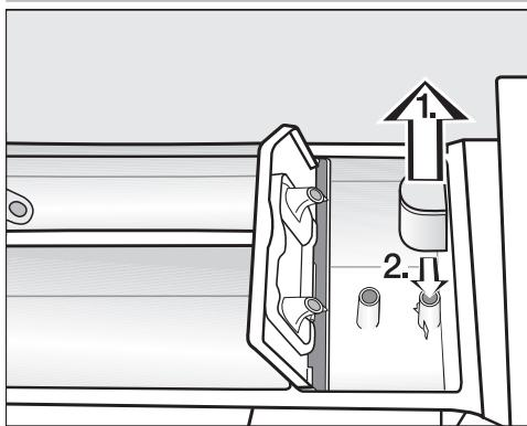
1. Usisnu cjevčicu izvucite iz pretinca
