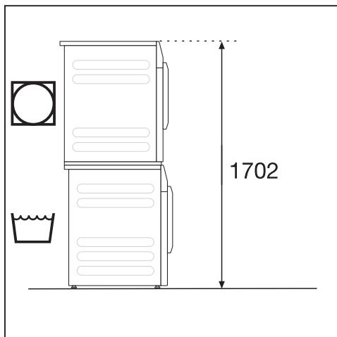
A máquina de lavar roupa pode ser instalada juntamente com uma máquina de secar roupa da Miele como uma coluna de lavar/secar. Para o efeito, é necessário um conjunto de ligação (acessório de aquisição posterior).
