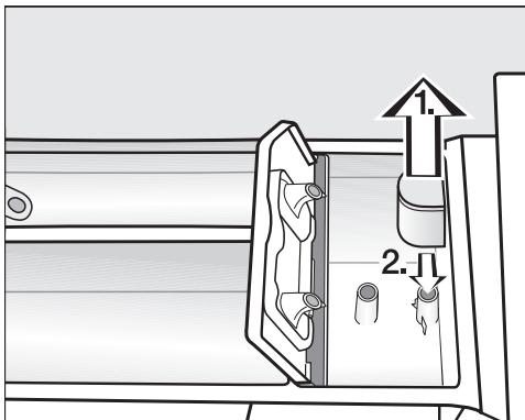
1. Trekk ut sugeheverten fra kammeret og rengjør under rennende varm vann. Rengjør også røret som sugeheverten settes på.
