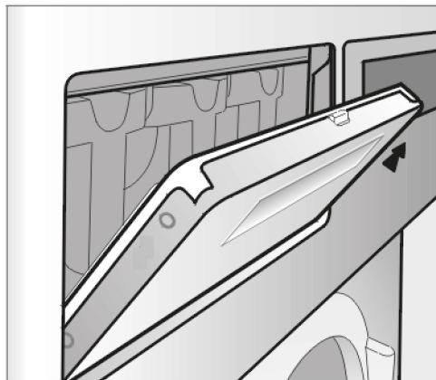
Im Falle einer Verstopfung der Tropfrinne und des zugehörigen Ablaufstutzens sind diese zu reinigen.
