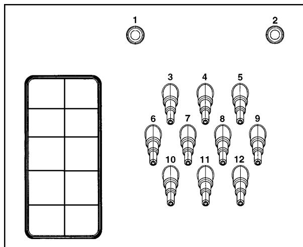
Die Anschlüsse **1** und **2** sind für Pastendosierung vorgesehen. Diese Anschlussstutzen sind verschlossen und müssen mit einem 8 mm-Bohrer durchbohrt werden.
