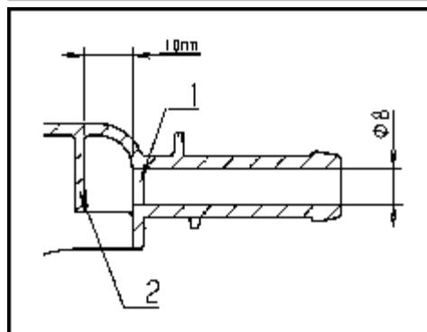
Es ist zu beachten, dass nur die erste Wand (1) durchbohrt wird, da sich 10 mm dahinter eine Prallwand (2) befindet.
