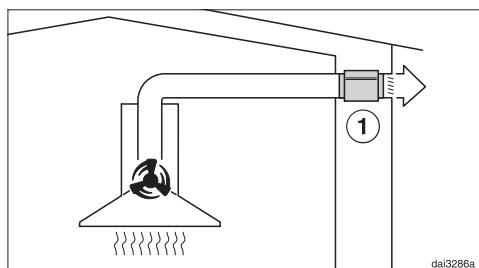
U sistemu odvoda vazduha, prigušivač zvuka prigušuje i buku ventilatora prema spoljnoj strani i spoljašnju buku koja preko cevi za odvod vazduha može da dospe u kuhinju (npr. ulična buka). Zbog toga se prigušivač zvuka pozicionira što je moguće bliže izlazu za odvod vazduha ①.
