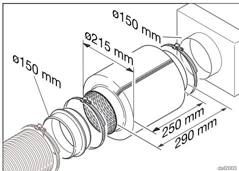
Za dodatno prigušivanje zvuka može se koristiti prigušivač zvuka u cevi za odvod vazduha (dodatna oprema koja se naknadno kupuje).
