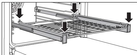
Nosivost FlexiClip teleskopskih vodilica iznosi maksimalno 15 kg.
