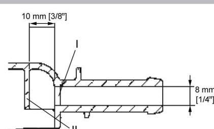
Beachten Sie, dass nur die erste Wand (I) durchbohrt werden darf, da sich bereits 10 mm hinter der ersten Wand eine Prallwand (II) befindet.
