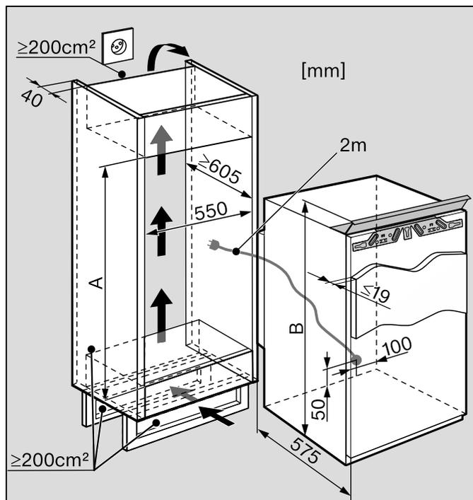
Prima di incassare l'apparecchio, controllare che il vano d'incasso abbia le dimensioni richieste. Le dimensioni per le aperture di aerazione e sfiato devono essere assolutamente mantenute per garantire il perfetto funzionamento dell'apparecchio.
