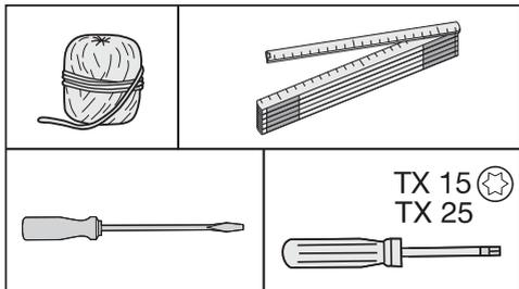
Per incassare l'apparecchio occorrono i seguenti strumenti:
