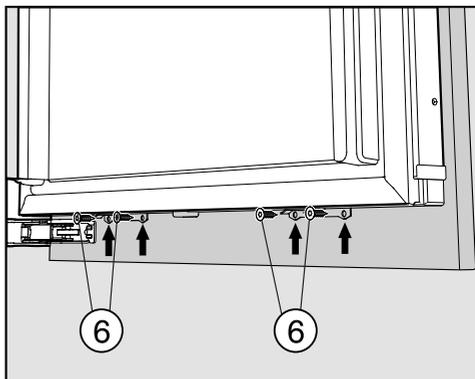
■ Fissare la squadretta di fissaggio allo sportello del mobile con le viti ⑥.
