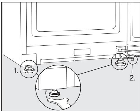
■ Richten Sie das Kältegerät mit Hilfe einer Wasserwaage und dem beiliegenden Gabelschlüssel aus und stützen Sie die Gerätetür ab.
