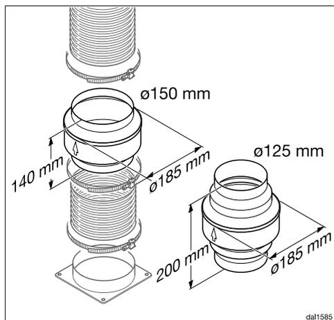
Se recomienda, junto con el aislamiento de la conducción de salida de aire, la instalación de un bloqueador de agua condensada que recoja y evapore el agua condensada.
