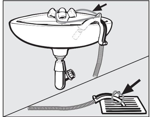
⚠ Risque de dommages dus à l'écoulement d'eau.
