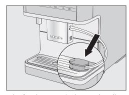
Insérez la vanne de rinçage dans l'ouverture à droite du bac d'égouttage et confirmez avec OK.
