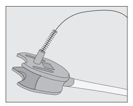
Nettoyez le corps de la vanne de rinçage avec le goupillon sous l'eau courante pour éliminer les résidus de lait
