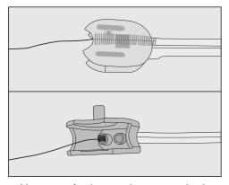
Nettoyez également les raccords de tuyau dans le corps de la vanne de rinçage : pour ce faire, insérez le goupillon dans les deux orifices et déplacez la brosse d'avant en arrière.
