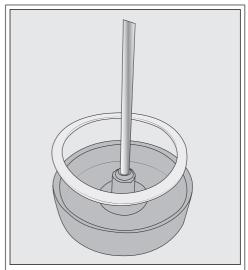
Si nécessaire, vous pouvez retirer la pièce de raccordement et la bague d'étanchéité du couvercle du récipient à lait. Une fois que vous avez retiré le tube en acier inoxydable, la pièce de raccordement peut être facilement sortie de l'intérieur du couvercle.
