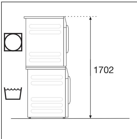
Un cadre de superposition\* (APCL001) est requis. Le montage doit être effectué par un technicien agréé par Miele. Sécurisez le lave-linge à l'aide de l'étrier de fixation fourni.
