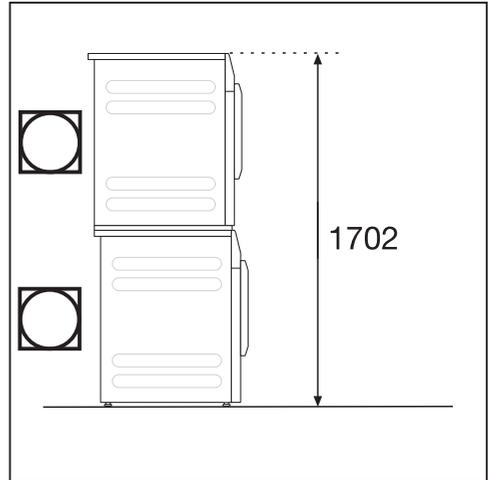
Deux sèche-linge Miele peuvent être superposés pour former une colonne. À cet effet, un cadre de superposition est nécessaire. Le montage doit être effectué par un technicien agréé par Miele.
