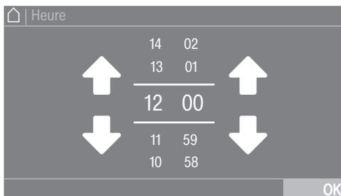
Entrez les chiffres en balayant l'écran vers le haut ou le bas. Placez un doigt sur le chiffre à modifier et déplacez-le dans la direction souhaitée. La touche sensitive OK permet d'enregistrer la valeur numérique configurée.
