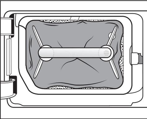
Os rebordos do filtro do rodapé não estão assentes e o filtro do rodapé está deformado. Nos rebordos assentes incorretamente, o algodão não filtrado é soprado para o permutador de calor. A longo prazo, isso obstrói o permutador de calor.
