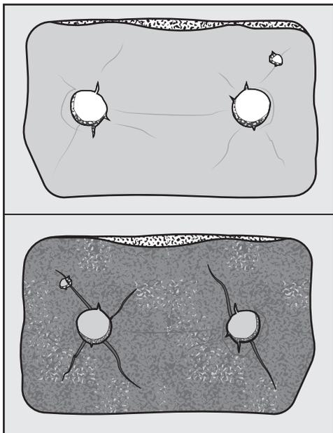
Devido a fendas e fissuras, o algodão é soprado para o permutador de calor. A longo prazo, isso obstrói o permutador de calor.
