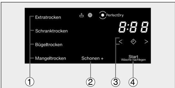
Die Sensortasten ①-④ reagieren auf Berührung mit den Fingerspitzen. Die Auswahl ist möglich, solange die jeweilige Sensortaste beleuchtet ist. Sensortaste  $\diamond$  = Startvorwahlzeit (dann Zeit mit < > wählen).
