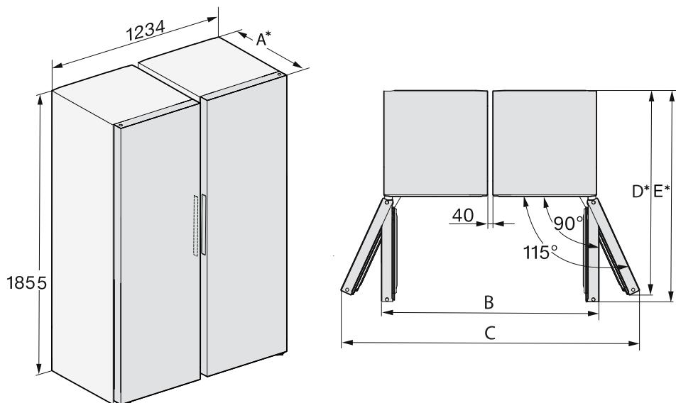
\* Dimenzije bez montiranih zidnih odstojnika. Ukoliko se koriste zidni odstojnici, povećava se dubina uređaja za 15 mm.
