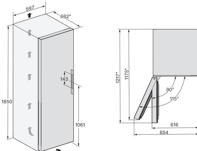
\* Dimenziije bez montiranih zidnih odstojnika. Ukoliko se koriste zidni odstojnici, povećava se dubina uređaja za 15 mm.
