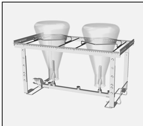
Flacoanele Erlenmeyer stau pe suportul ramei suport a modulului. Conul din partea inferioară a duzei cu injector ar trebui să fie pe interiorul gâtului vaselor și instrumentelor. Aceasta protejează marginea de fisuri.
