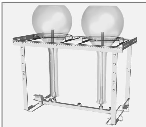
Baloanele cotate stau pe suportul ramei suport a modulului. Conul din partea inferioară a duzei cu injector ar trebui să fie pe interiorul gățului vaselor și instrumentelor. Aceasta protejează marginea de fisuri.
