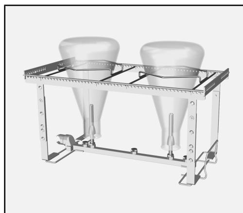
Erlenmeyer şişeleri modülün tutucu çerçevesindeki taşıyıcı üzerinde durur. Enjektör ucunun alt ucundaki konik kısmı, yeniden işlenecek malzemeyi boynunun içinde bulunmalıdır. Bu şekilde boyun kenarı çatlamalarla karşı korunur.
