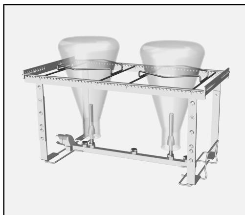
三角フラスコは、モジュールフレームのサポートに挟み込むように搭載します。インジェクターノズルの底部のコーンがアイテムの首の中に入るように配置します。これにより、縁が欠けるのを防ぎます。
