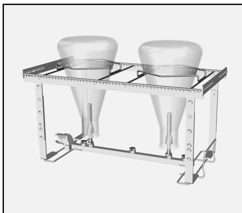
Колбы Эrlenмейера лежат на подложке в рамке модуля. Конус на нижнем конце инжекторного сопла должен находиться внутри горлышка обрабатываемой посуды. Это позволяет защитить край от растрескивания.
