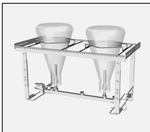
Kolby Erlenmeyera opierają się na nakładce w ramie podtrzymującej modułu.
