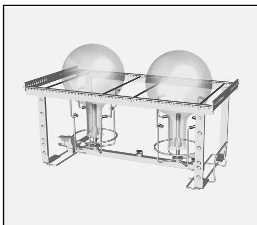
圆底烧瓶置于支架的 4 个点上；瓶颈不应接触供水管。
