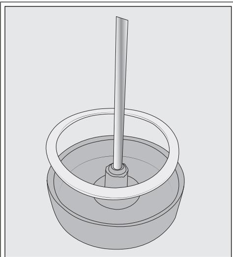
En caso necesario, se pueden retirar la pieza de conexión y la junta anular de la tapa del recipiente. Una vez que se haya retirado el tubo de acero inoxidable, se puede extraer fácilmente la pieza de conexión de la parte interior de la tapa.
