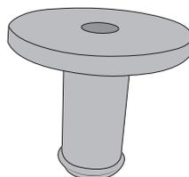
La pieza de conexión se incluye en el suministro de la máquina y se coloca o bien en el tubito para la leche o bien en la tapa del recipiente para la leche.
