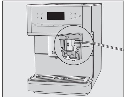
**Consejo:** La "soldadura" entre el conducto para la leche y la salida central facilita el montaje correcto.
