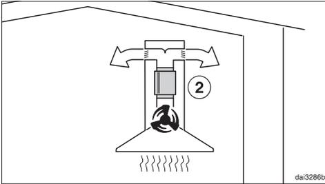
Le réducteur de bruit est positionné entre le raccord de sortie d'air et le manchon de déviation (2). Vérifier que l'espace nécessaire au montage est disponible.
