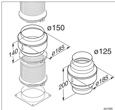
Outre l'isolation adéquate de la conduite d'évacuation, il est recommandé d'installer un piège à eau condensée chargé de capter et d'évaporer l'éventuelle condensation. Ce dispositif est disponible dans le commerce spécialisé pour une conduite d'évacuation de 125 mm ou de 150 mm de diamètre.
