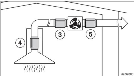
Pour réduire les bruits de ventilation dans la cuisine, le réducteur de bruit doit être positionné, si possible, devant le ventilateur externe (3), et en cas de conduite d'évacuation longue, sur le raccord de sortie d'air de la hotte (4). En cas de ventilateur externe monté dans la maison, il est possible de réduire le bruit de ventilation sortant vers l'extérieur en intégrant un réducteur de bruit derrière le ventilateur externe (5).
