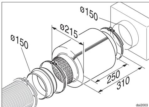
Il est possible d'installer un réducteur de bruit dans la conduite d'évacuation (accessoire en option). Il sert à réduire encore le niveau sonore de l'appareil.
