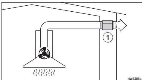
Le réducteur de bruit réduit aussi bien les bruits du ventilateur transmis à l'extérieur que ceux provenant de l'extérieur par la conduite d'évacuation (p. ex. les bruits de la rue). Pour ce faire, le réducteur de bruit doit être placé le plus près possible de la sortie d'air ①.
