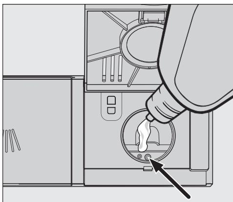
■ Versare solo la quantità di brillantante finché l'indicazione di livello di riempimento (freccia) si colora di scuro quando lo sportello è aperto in posizione orizzontale.
