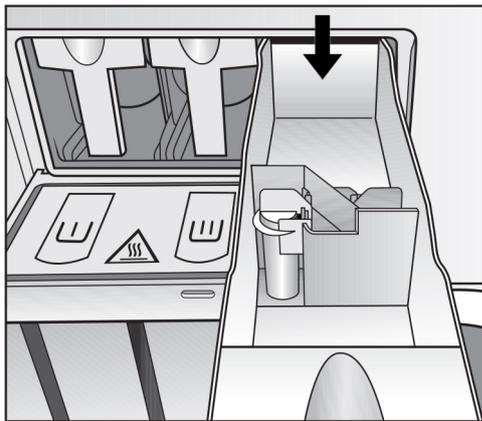
I candeggianti liquidi possono essere versati solo nella parte posteriore della vaschetta  $\text{Ⓢ}$ . Solo in questo modo si garantisce che il prodotto candeggiante venga introdotto correttamente in macchina con il 2° ciclo di risciacquo. L'aggiunta di candeggiante liquido per i capi colorati è sicura solo se il produttore di capi consente espressamente il candeggio sull'etichetta.
