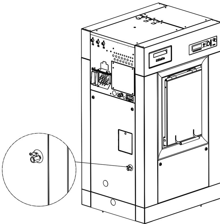
La valvola a sfera sul lato dell'involucro è chiusa trasversalmente alla direzione del flusso e aperta longitudinalmente alla direzione del flusso.
