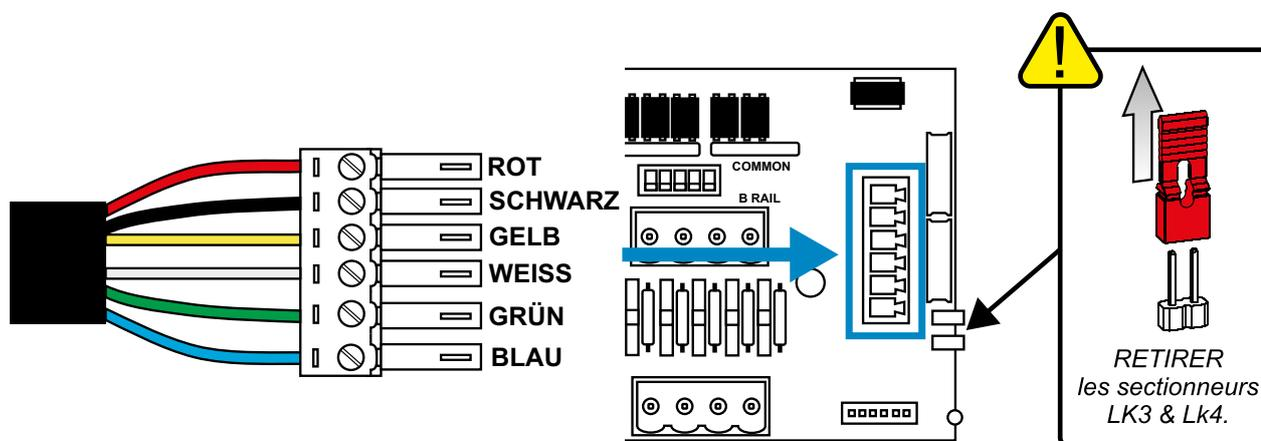
Den grünen Anschluss anbringen, wobei sich die farbigen Drähte in der oben gezeigten Reihenfolge befinden müssen. Den Anschluss in die richtige Buchse einsetzen und die Stopfbüchse zur Befestigung des Kabels festziehen.
