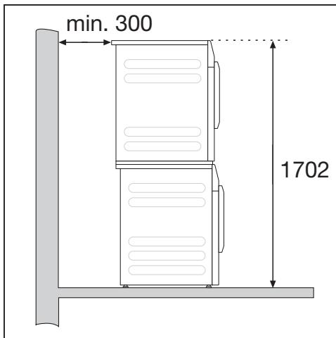
Vaskemaskinen kan settes sammen med en Miele tørketrommel til en vask-tørk-søyle. Det krever en mellomsats (ekstrautstyr).
