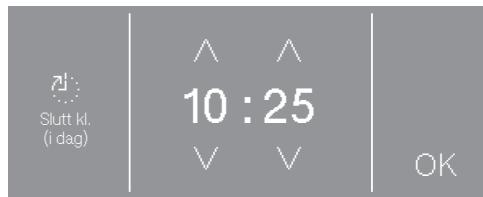
Berør pilene  $\wedge$  og  $\vee$  og bekrefte med sensortasten OK.
