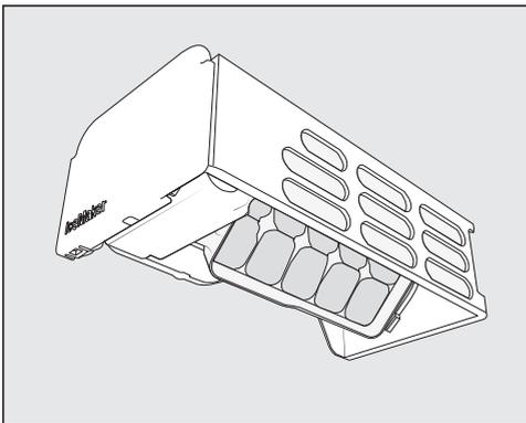
Sobald das Wasser gefroren ist, fallen die Eiswürfel aus der integrierten Eiswürfelschale automatisch in die Schublade. Die Eiswürfelschale kann nicht entnommen werden.
