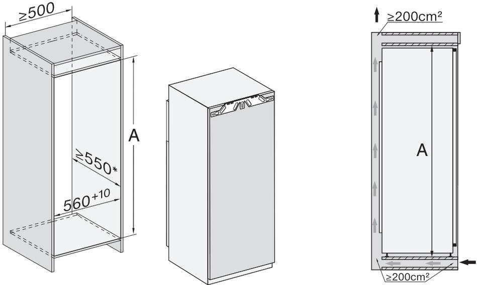
\* Para el consumo de energía declarado se ha tenido en cuenta un hueco de empotramiento de 560 mm. El aparato está equipado para funcionar a pleno rendimiento en un hueco de empotramiento de 550 mm, lo que aumenta ligeramente el consumo energético.
