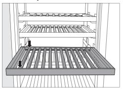
Colocar los listones de madera en las rejillas de madera a la misma distancia y encajarlos en esa posición.
