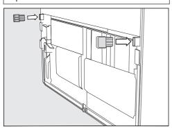
Montar en la parte inferior izquierda e inferior derecha de la pared posterior del acondicionador de vino los soportes distanciadores de pared.
