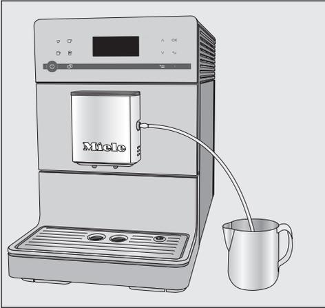
■ Coloque o recipiente ao lado da máquina de café e introduza o tubo do leite na solução de limpeza. Certifique-se de que o tubo do leite fica suficientemente imerso na solução se limpeza.
