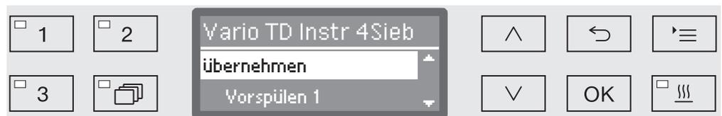
Im Display sind alle Spülblöcke aufgelistet, die dem Programm zugeordnet sind. Die Zuordnung kann bei Bedarf durch den Kundendienst angepasst werden.
