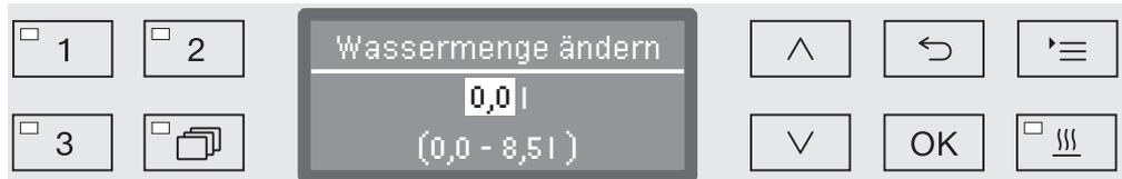
Die Wassermenge kann in 0,5 l Schritten erhöht oder wieder auf die Werkeinstellung zurückgesetzt werden. In der untersten Zeile ist der mögliche Einstellungsbereich angegeben. Der Einstellung „0 l“ entspricht der Werkeinstellung.
