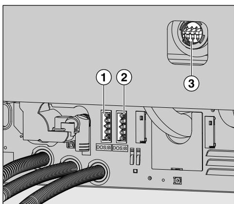
① Anschluss Stromversorgung DOS 1 Reiniger.
