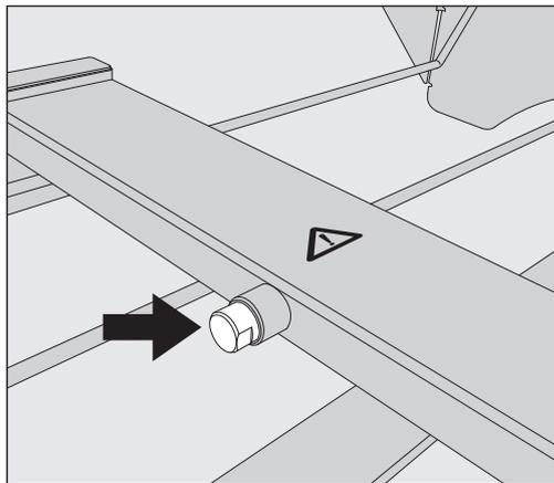
An dem Messzugang dürfen unter keinen Umständen Spülgut, Spülvorrichtungen usw. angeschlossen werden. Nach der Messung muss der Zugang wieder mit der Blindschraube verschlossen werden.
