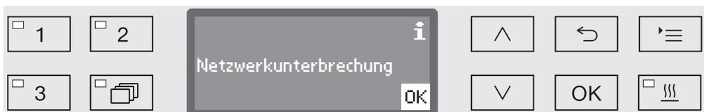
Der laufende Aufbereitungsprozess wird ohne Unterbrechung fortgesetzt und die Prozessdaten im internen Speicher zwischengespeichert.
