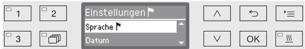
Mit Hilfe der Pfeiltasten  $\wedge$  und  $\vee$  auf dem Bedienpult kann durch das Menü navigiert werden.
