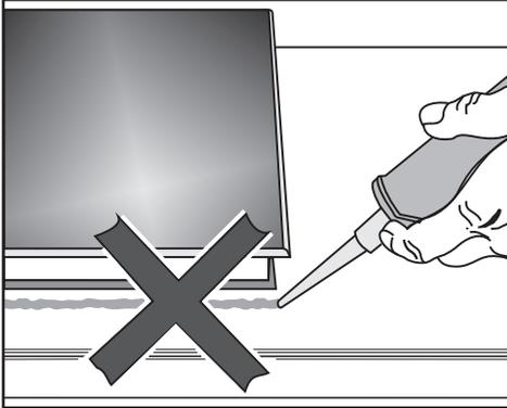
⚠ Schäden durch falschen Einbau. SmartLine-Element und Arbeitsplatte können bei einem eventuell erforderlichen Ausbau des ProLine-Elements beschädigt werden, wenn Sie das SmartLine-Element mit Fugendichtungsmittel abdichten.
