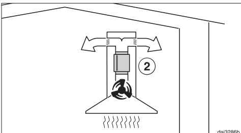
En caso de funcionamiento con recirculación de aire, el amortiguador de ruido se coloca entre las bocas de expulsión y la desviación (2). Compruebe la estancia donde está colocada.
