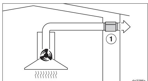
El silenciador amortigua tanto los ruidos del ventilador hacia fuera como los ruidos exteriores que entran en la cocina a través de la conducción de salida de aire (p. ej. el ruido de la calle). Para ello, el silenciador se coloca lo más cerca posible de la salida de aire (1).
