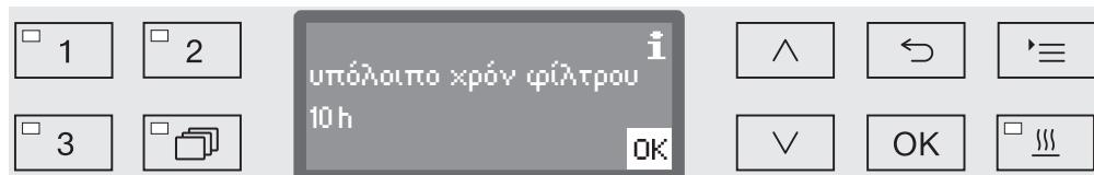
Στη συνέχεια στην οθόνη εμφανίζονται οι υπολειπόμενες ώρες λειτουργίας γι' αυτόν τον τύπο φίλτρου.
