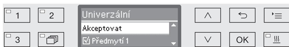
Přiřazení se provádí vícenásobným výběrem. V zobrazení na displeji je před všemi mycími bloky zaškrťávací políčko . Pokud je mycí blok přiřazený programu, vidíte v něm zatržítko . Výběrem mycích bloků lze tyto mycí bloky přiřadit programu nebo přiřazení zase zrušit.
