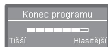
Stupeň hlasitosti se znázorňuje sloupcovým indikátorem. Na nejnižším nastavení je signál bzučáku vypnutý.
