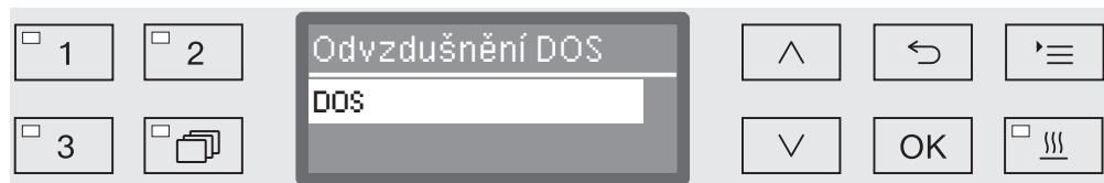
Výběrem dávkovacího systému se spustí automatické odvzdušnění. Po spuštění již automatické odvzdušnění nelze stornovat.
