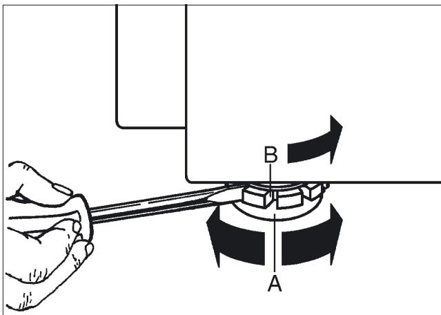
Ρυθμίζοντας τα βιδωτά πόδια **A** ευθυγραμμίζετε οριζόντια και σταθεροποιείτε τη συσκευή.
