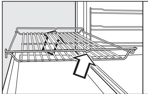
Inserire gli accessori con il dispositivo di arresto situato posteriormente.
