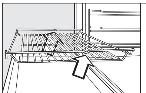
Schieben Sie die Teile mit dem Ausziehschutz nach hinten ein.
