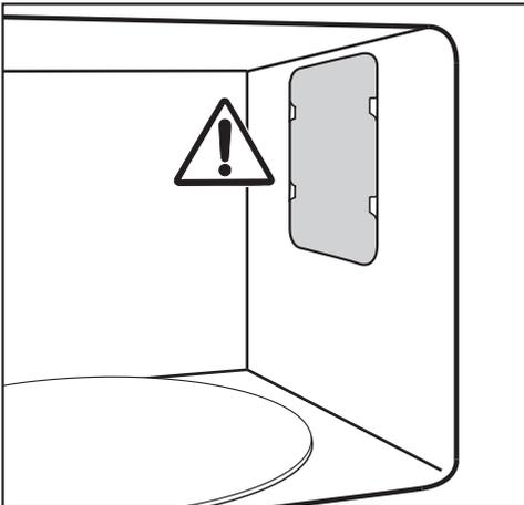
N'enlevez ni le cache de protection de l'orifice de sortie des micro-ondes dans l'enceinte ni le film collé sur la contreporte.
