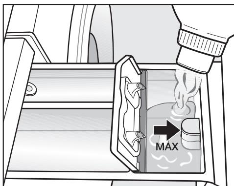
■ Aviváž, tužidlo alebo tekutý škrob dávajte do komory . **Dbajte na maximálnu výšku naplnenia.**
