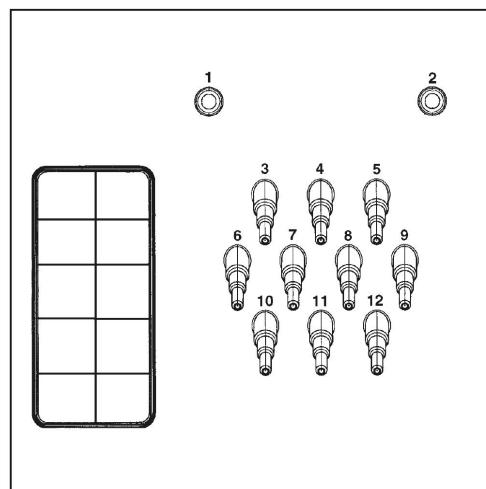
Raccords pour la pompe de dosage au dos de l'appareil
