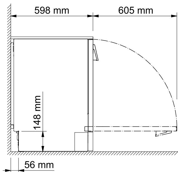
Zona delantera del zócalo en función del tipo de aparato
