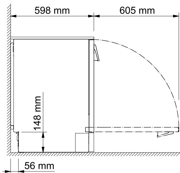
area zoccolo anteriore divergente a seconda del modello di macchina
