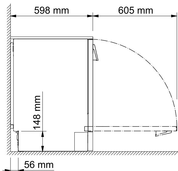
La surface du socle avant varie en fonction du type d'appareil.
