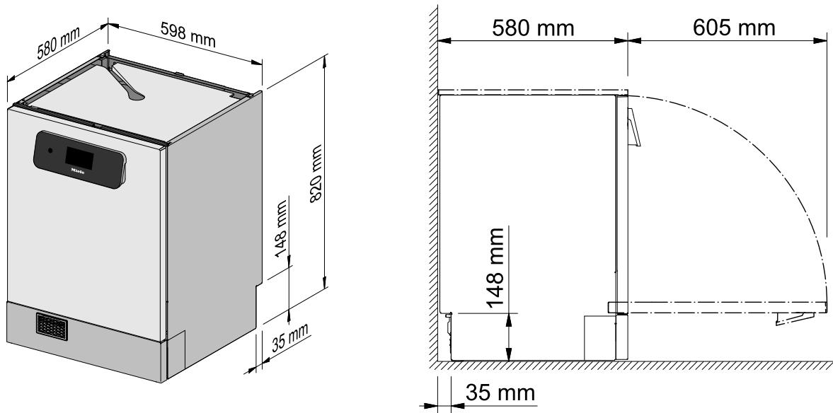
La surface du socle avant varie en fonction du type d'appareil.
