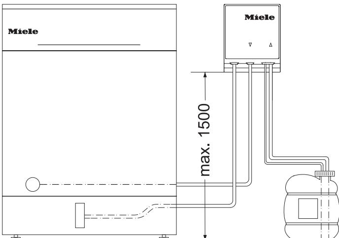
Altura de elevación máx. 1,5 m
