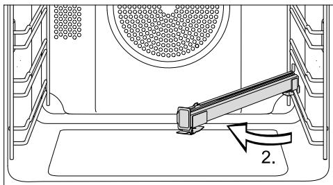
■ Поверните телескопическую направляющую FlexiClip в центр рабочей камеры (2).
